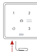
Le mode appairage est validé lorsque quatre LEDs s'allument l'une après l'autre (allumées 0,5 sec, la suivante s'allume lorsque la précédente s'éteint).
