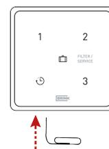
L'appairage est validé lorsque quatre LEDs s'allument l'une après l'autre (allumées 0,5 sec, la suivante s'allume lorsque la précédente s'éteint).
