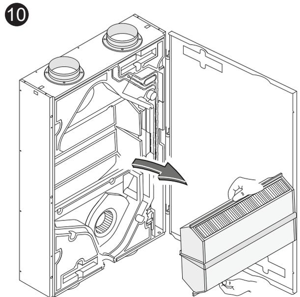
Bei Deckenmontage den Kondensatbehälter vorsichtig lösen. Es kann sich nämlich noch eine geringe Kondenswassermenge im Kondensatbehälter befinden!
