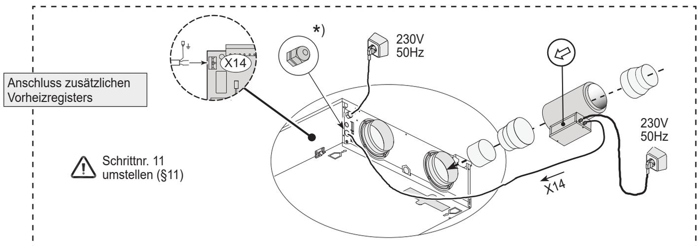
9.7 Anschluss Erdwärmetauscher
